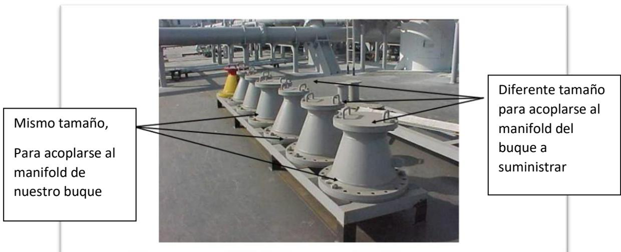
*Ilustración 2: Reducciones para manifold. Fuente: Sitio web; <https://knowledgeofsea.com/tanker-various-parts/>
