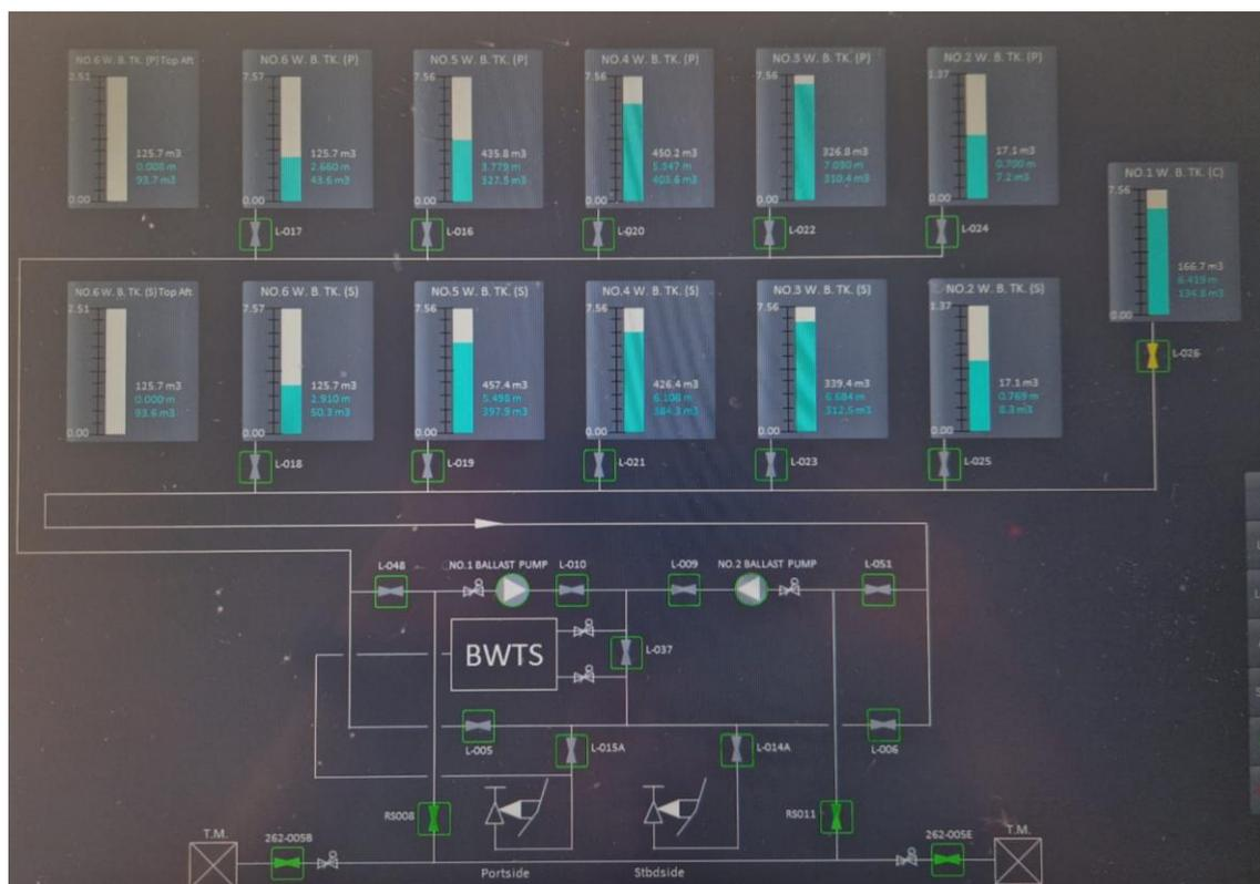
*Ilustración 7* Panel de válvulas del sistema de lastre. Fuente: Elaboración propia.
