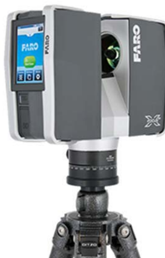
Fig. 2. Escáner 3D FARO X130 utilizado para el proyecto. [13].
