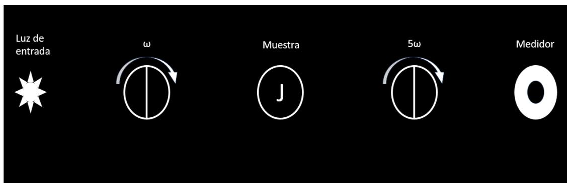
Figura 3.1: Esquema de la disposición del polarímetro estudiado.
