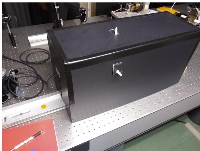
Figura 3.5: Caja conectada al láser supercontinuo, contiene la fibra óptica multimodo y el monocromador.
