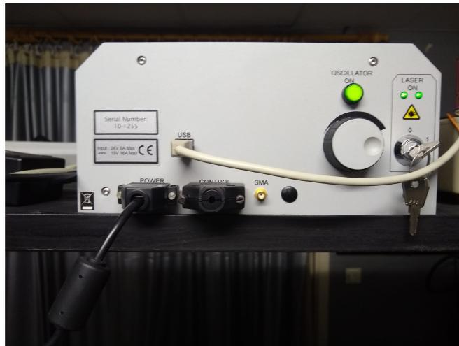
Figura 3.4: Láser supercontinuo utilizado en el montaje
