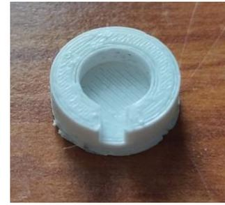
Figura 16, Soporte impreso en 3D para la sonda de LDF
