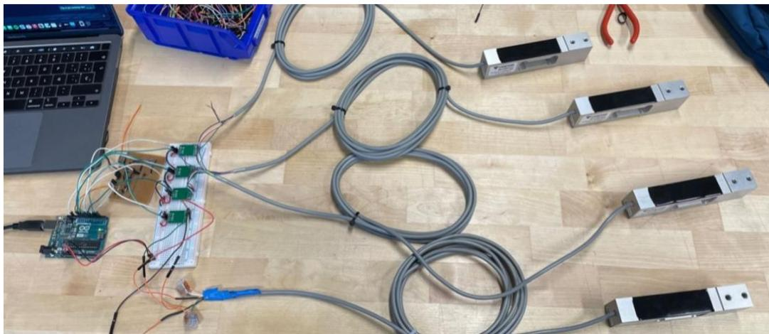
Figura 10, Conexión de las cuatro celdas de carga a sus respectivos amplificadores HX711
