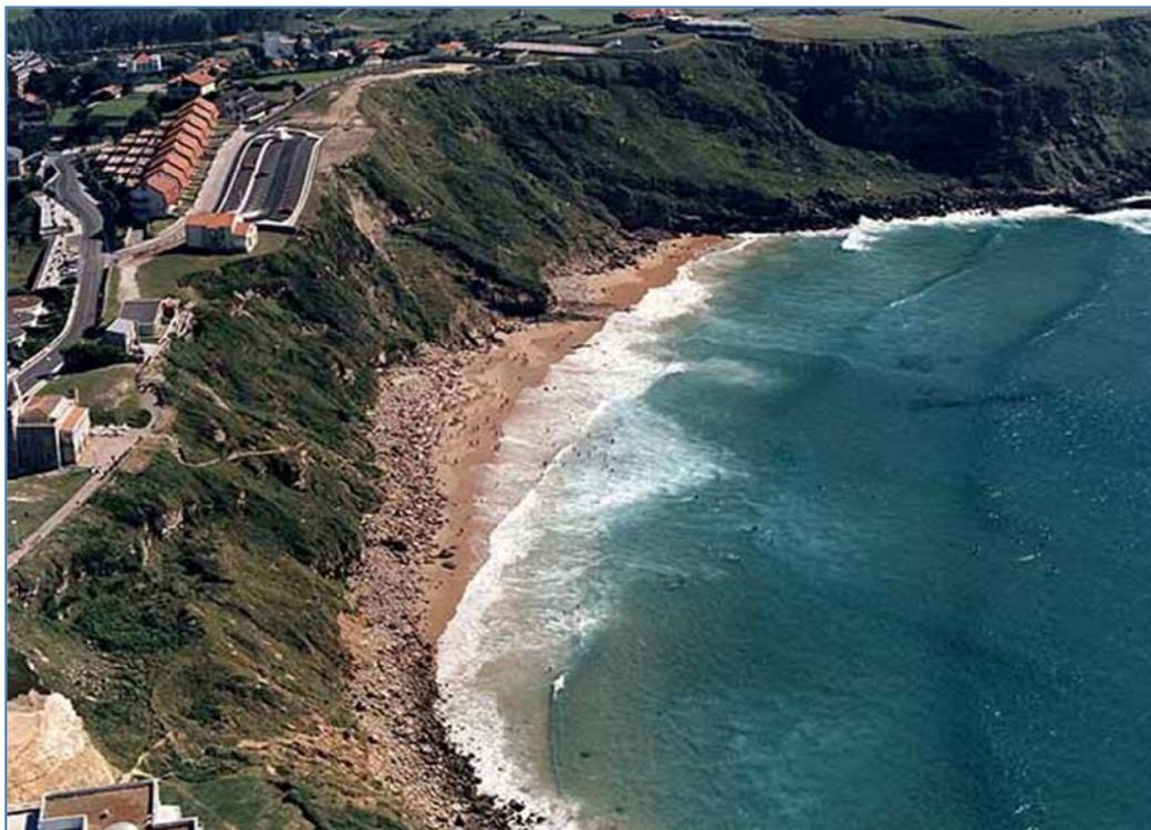
**Figura 5.5.** Playa de Los Locos (Suances), donde se observan los deslizamientos rotacionales en toda la franja izquierda. Al fondo, de mayor tamaño, se observa otro movimiento de mayores dimensiones.
