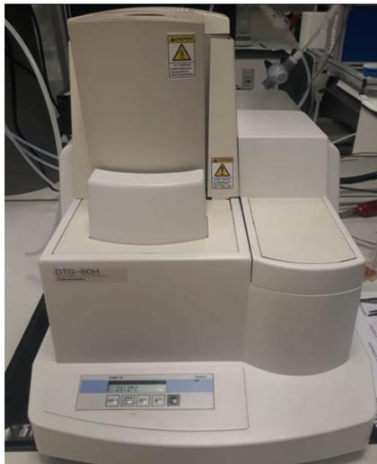
Figura A.2. Termobalanza TGA-DTA Shimadzu.
