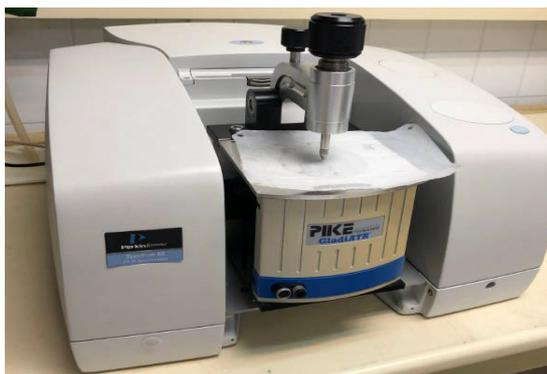
Figura A.3. Espectrómetro PIKE technologies GladiATR-Perkin Elmer Spectrum 65.
