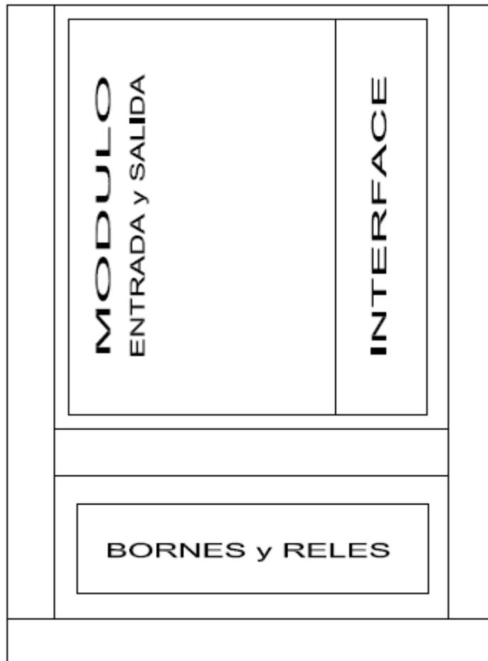
**Fig. 3.1:** Disposición del cuadro eléctrico.
