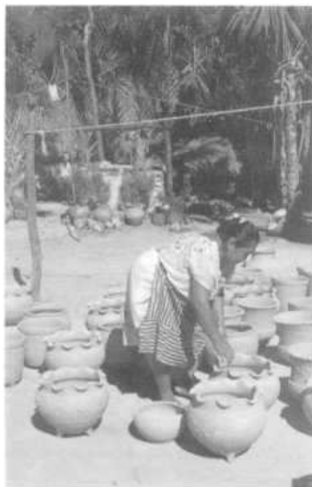
FIGURA 3a.—Silvia Cahún asoleando las ollas antes de meterlas al horno.
