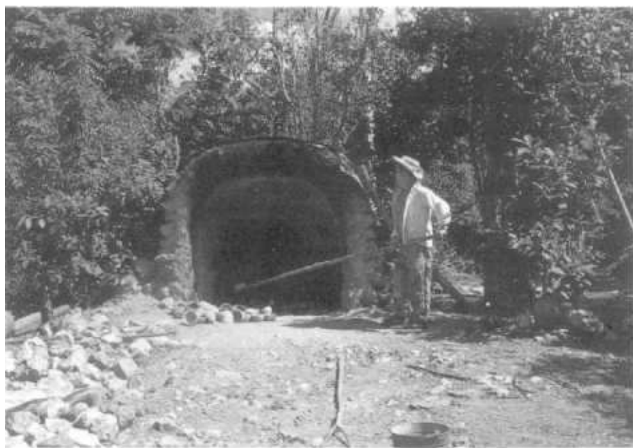
FIGURA 5b. — Una vez extinguido el fuego, las piezas son sacadas del horno con ayuda de una vara o pértiga larga.
