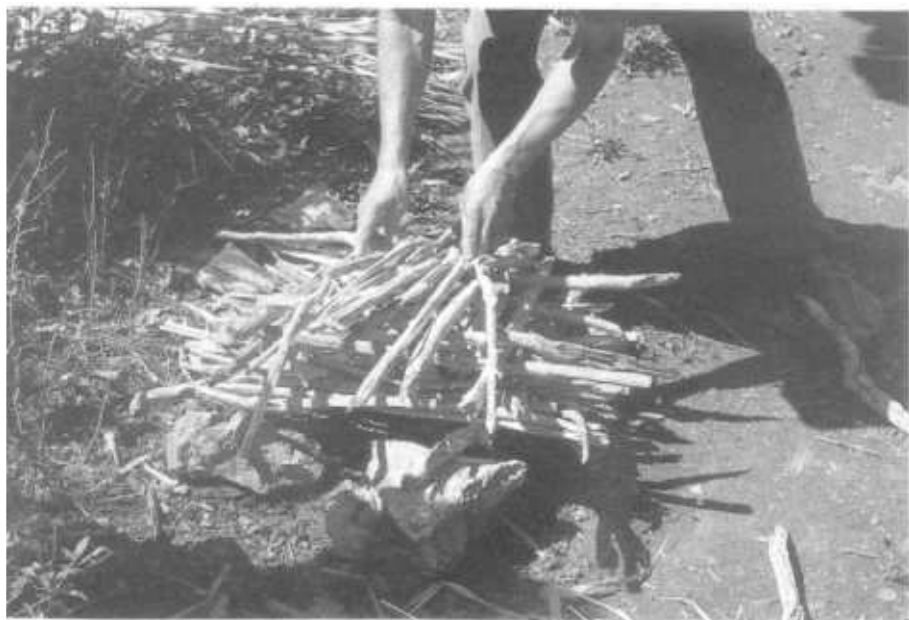
FIGURA 6b. — Preparativos finales. Las piezas son recubiertas con madera.
