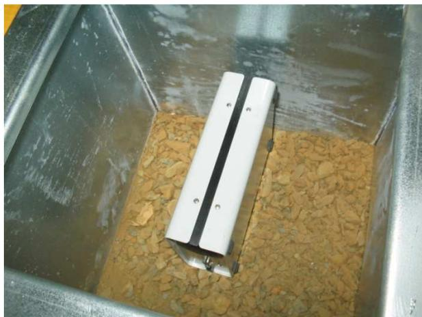
Figura 9: Perspectiva de la cámara primaria en la que se encuentra la tierra con un factor de producción de radón alto, y el detector Radon Scout SARAD.
