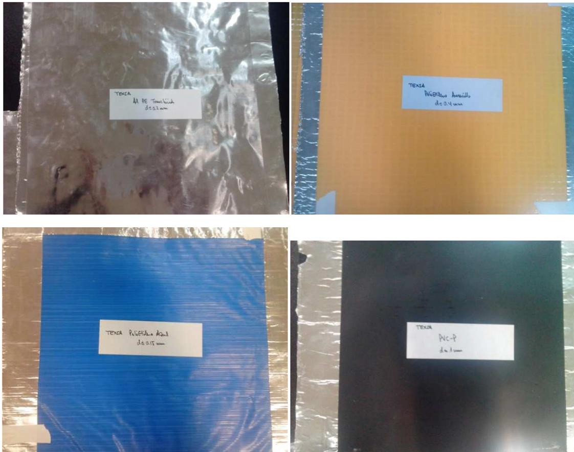
Figura 14: Membranas testeadas. Arriba a la izquierda lámina de Aluminio-Papel; a la derecha, lámina de polietileno. Abajo a la izquierda membrana con poliolefinas, y derecha lámina de bitumen.
