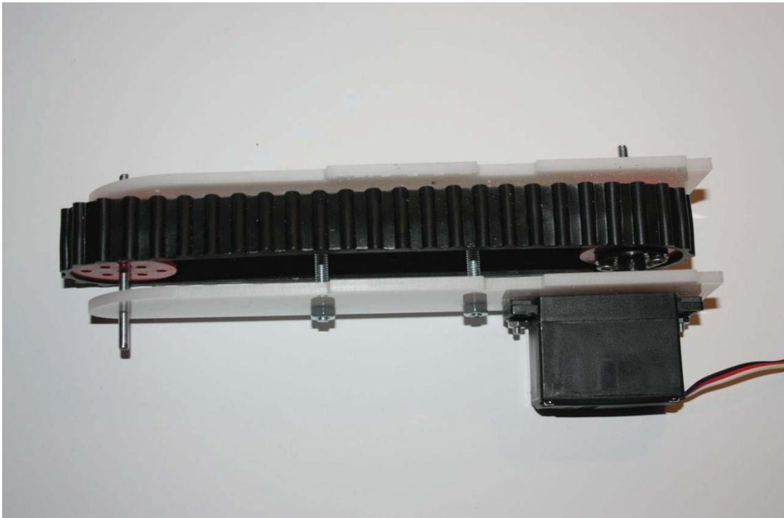
Ilustración 27 Detalle de la motorización del Aurebot
