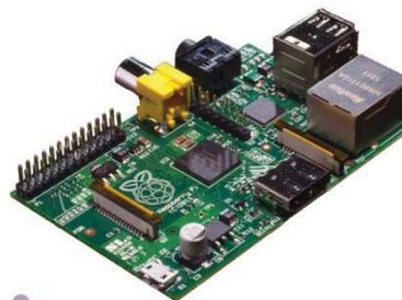
Ilustración 13 Raspberry Pi Modelo B
