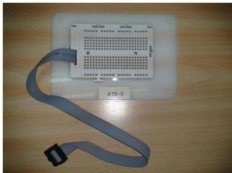
Ilustración 26 Placa de prototipos incluida en los Aurebots
