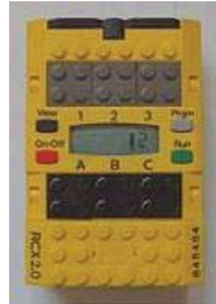
Ilustración 8 Bloque RCX de Lego Mindstorms
