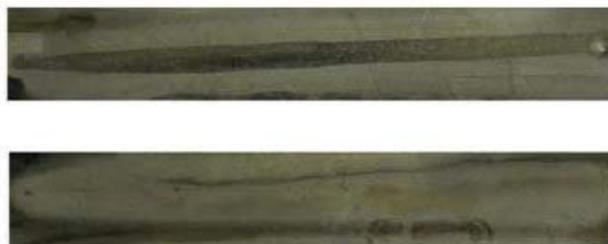
Figura 3.18. Cordón de la soldadura de Ti 6A1-4V
