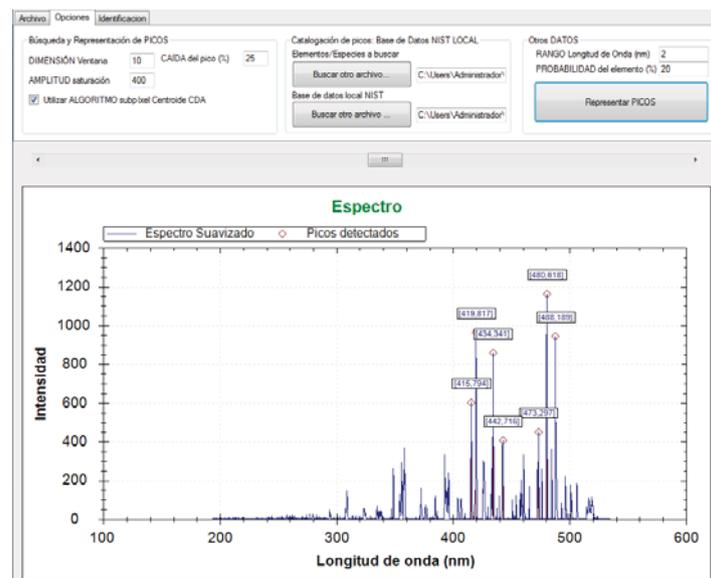
Figura 3.10. Longitud de onda de los picos detectados aplicando algoritmo CDA
