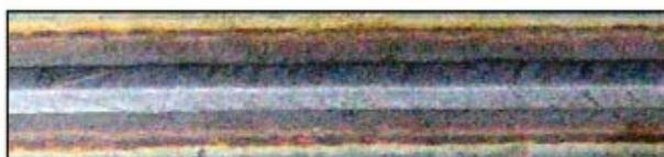
Figura 3.44. Cordón soldadura de acero inoxidable ASI-304 sin defectos
