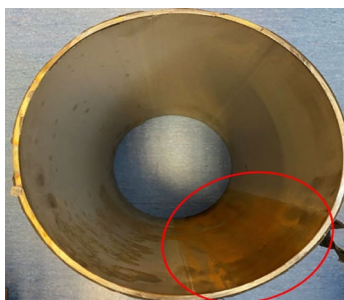
Figura 4. Área (elipse roja) con depósitos de productos de corrosión; cara interior del tubo.
