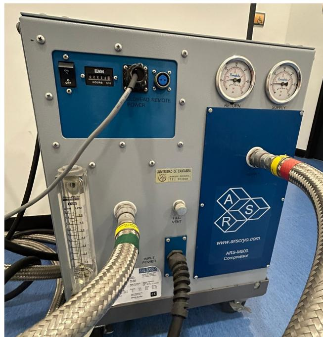
Figura 7: Compresor de helio del criostato
