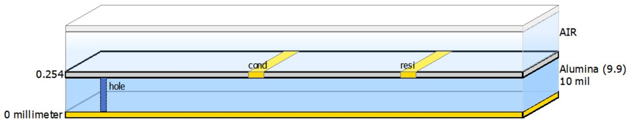
Figura 39: Substrato de simulación en ADS
