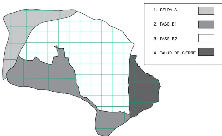
Figura 3-11. Zonificación del vertedero según potencial de emisión superficial y mallado propuesto para distribución de puntos de medida.
