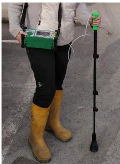
**Figura 3-9. Sonda de muestreo para la realización del walkover.**
