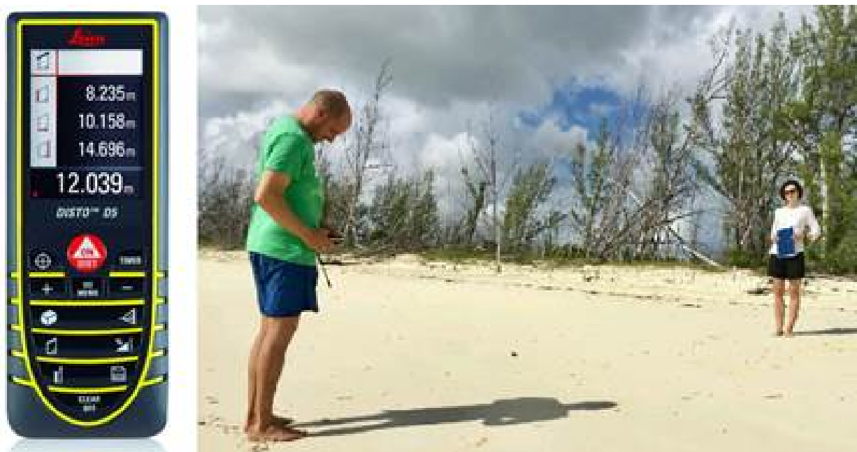
Figura 1. Izquierda: Medidor de distancias laser. Derecha: Trabajo de campo durante la medición de un perfil de playa empleando el medidor de distancias laser.
