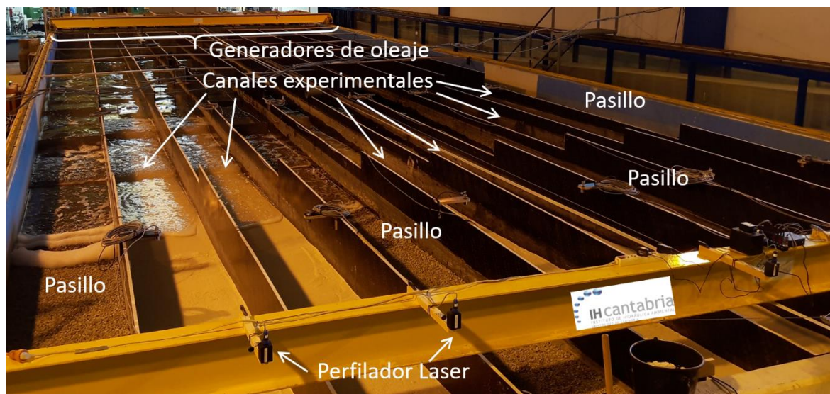
Figura 16 Tanque de oleaje direccional (TOD) durante los ensayos.
