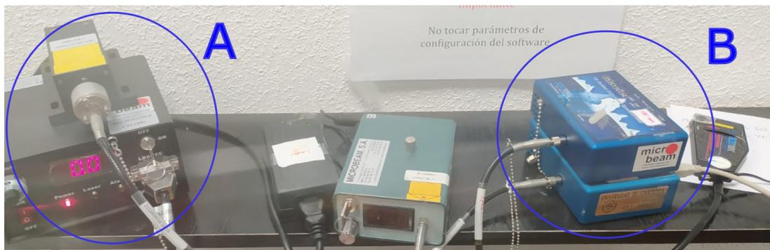
**Figura 3.5:** Componentes del raman portátil utilizado para medir la fluorescencia de las muestras. Se puede observar A) el generador LASER de 532nm y en B) el monocromador
