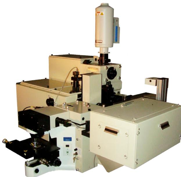
**Figura 3.4:** Fotografía del espectrómetro Raman Horiba T64000 utilizado. Imagen obtenida del catálogo de DirectIndustry.
