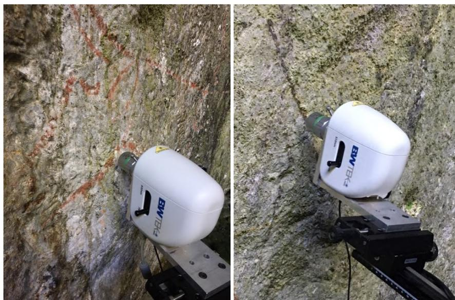
**Figura 1.4:** Fotografías de la sonda de microespectroscopía raman utilizada por el grupo de altas presiones y espectroscopía de la Universidad de Cantabria. En (figura izquierda) se observa la sonda apuntando a depósito ocre de óxidos de hierro y en (figura derecha) a depósitos de óxidos de manganeso. Autoría de la fotografía: Jesús González.
