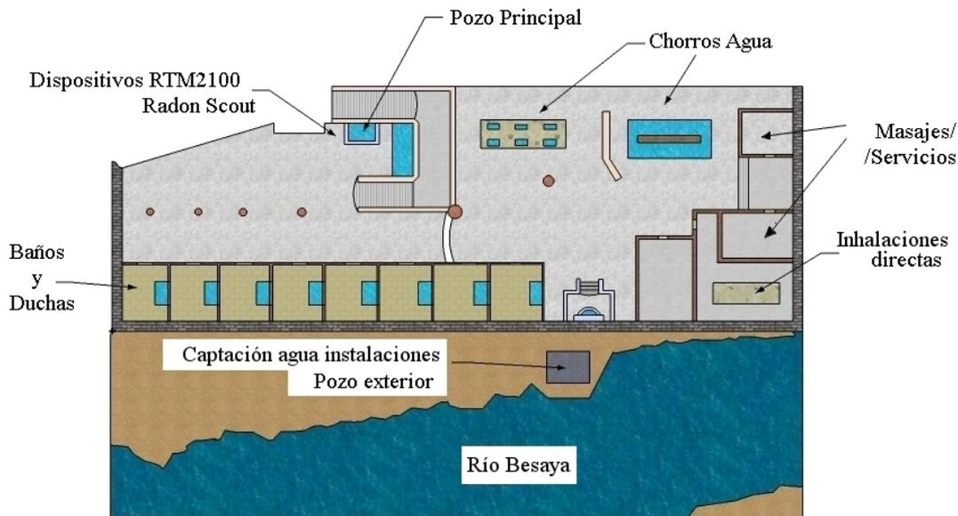
Figura 7. Esquema de la sala de termas del balneario Las Caldas de Besaya.
