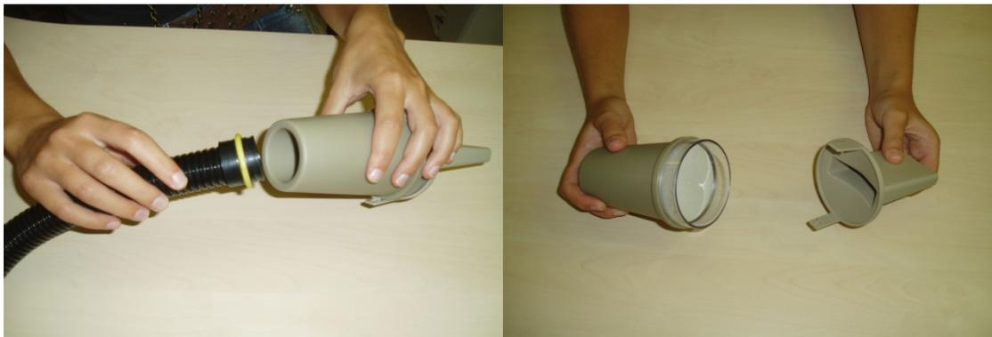
**Figura 6:** Dispositivo colector de polvo doméstico acoplable a aspirador
