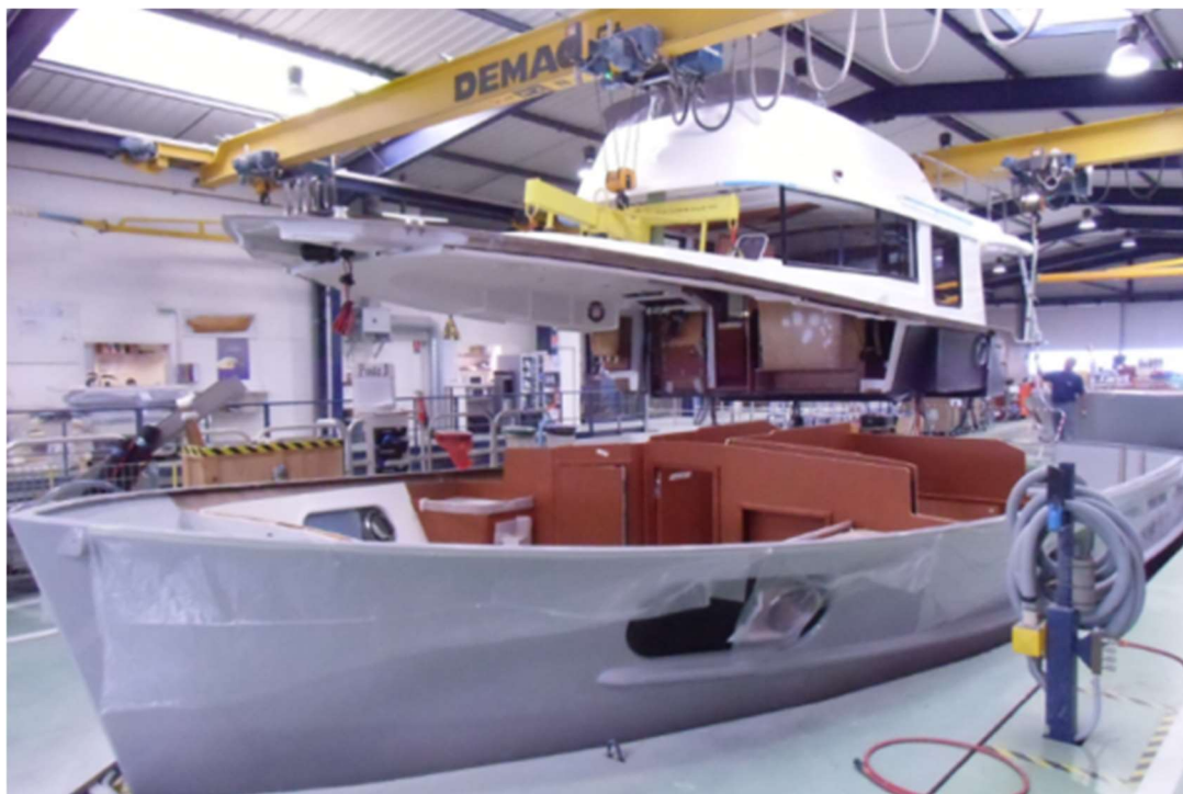
Figura 62: Ensamblaje de la cubierta y del casco con adhesivo estructural (boatindustry.es)
