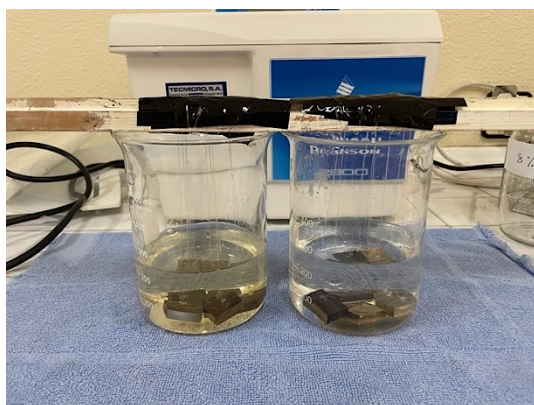
Figura 41: Colocación de las probetas en el interior del vaso de precipitados para su posterior introducción en el baño de ultrasonidos. Fuente: Elaboración propia.
