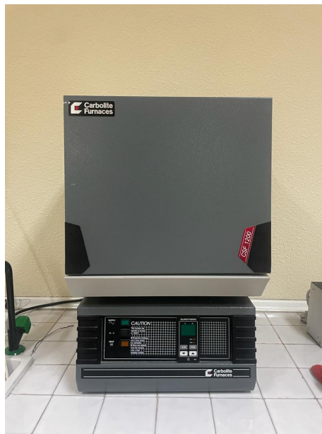
Figura 30: Horno Carbolite Furnaces CSF 1200 para la realización de tratamientos térmicos. Fuente: Elaboración propia.
