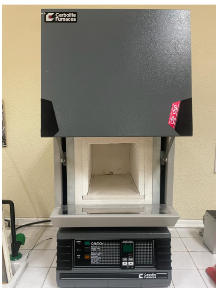
Figura 31: Interior cerámico del horno CARBOLITE FURNACES CSF 1200. Fuente: Elaboración propia.
