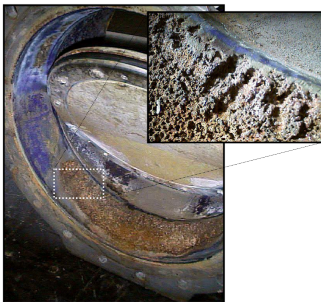
Figura 5: Daño por cavitación en una válvula de mariposa
