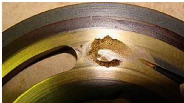
Figura 12: Turbina dañada por corrosión por cavitación
