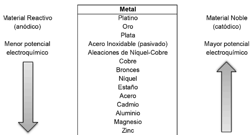
Figura 8: Serie galvánica (ideal) para algunos metales y aleaciones comunes. Fuente: Referencia [16].
