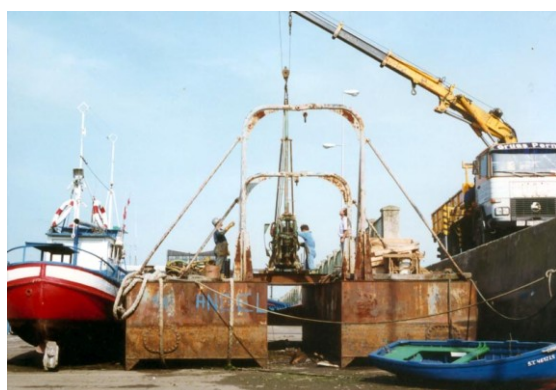
Figura 2.6: Sonda de ICINSA montada sobre flotadores (Puerto de Santander)
