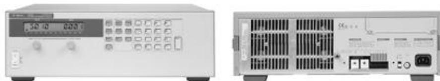
**Figura 3.7. Fuente de alimentación Modelo 6654A (Agilent) utilizada en el laboratorio**
