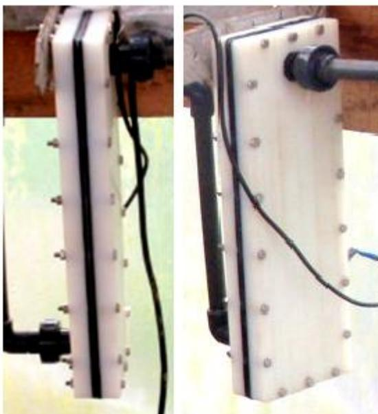
**Figura 3.11. Fotografías de la celda de electro-oxidación Magneto Special Anodes B.V.**
