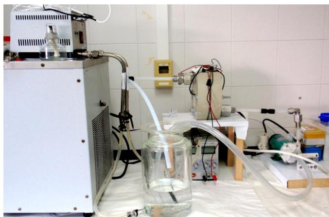
**Figura 3.15. Sistema experimental utilizado en los experimentos de inactivación de virus mediante electro-oxidación**
