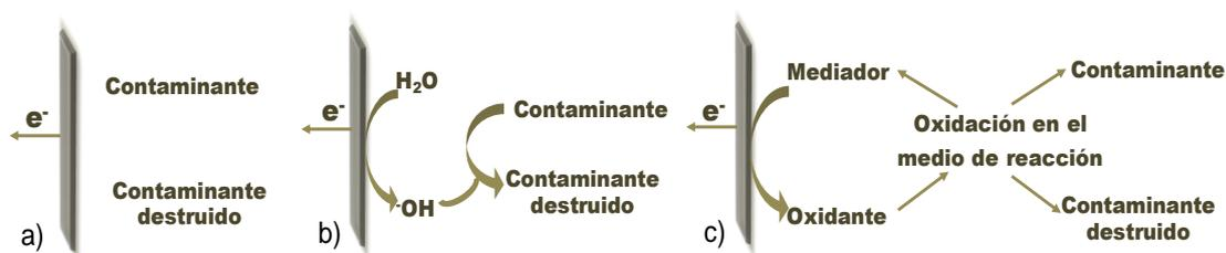
**Figura 1.19. Mecanismos de eliminación de contaminantes mediante procesos electroquímicos: a) directo; b) a través de los radicales hidroxilo producidos y c) a través de mediadores inorgánicos**
