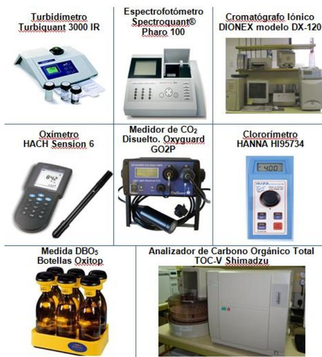
Figura 3.17. Equipos utilizados en los análisis físico-químicos de agua de mar
