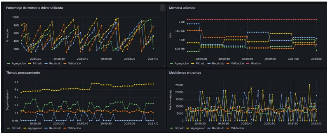
Figura 36. Rendimiento en varios nodos con 8000 mediciones/segundo.
