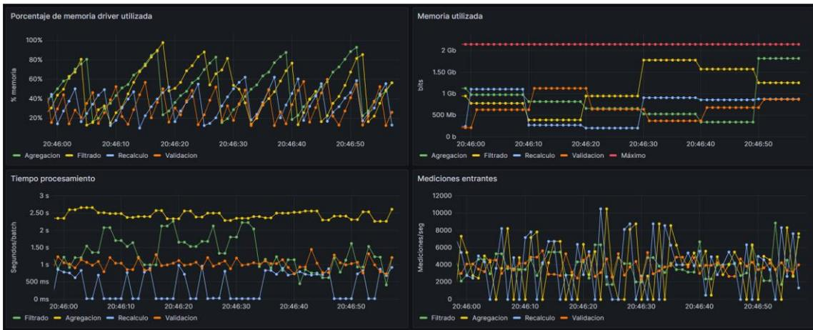
Figura 35. Rendimiento en varios nodos con 4000 mediciones/segundo.
