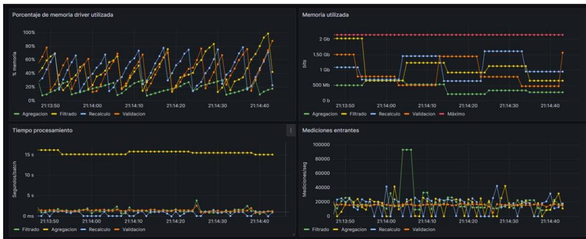
Figura 38. Rendimiento en varios nodos escalada con 20000 mediciones/segundo.
