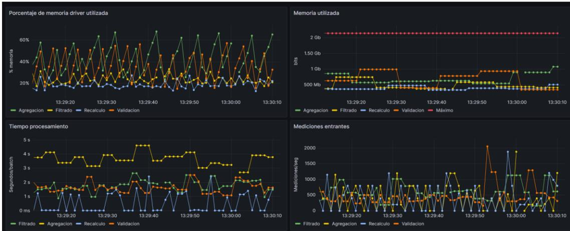
Figura 24. Rendimiento en un nodo con 400 mediciones/segundo.
