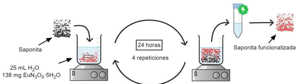
Figura 4: Visualización esquemática del procedimiento de intercambio catiónico seguido en el trabajo.
