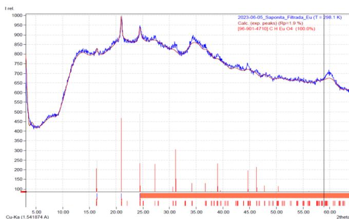
Figura 10: Coincidencias entre el difractograma obtenido para la saponita funcionalizada obtenida por centrifugado y el difractograma correspondiente al hidróxido carbonatado de europio.
