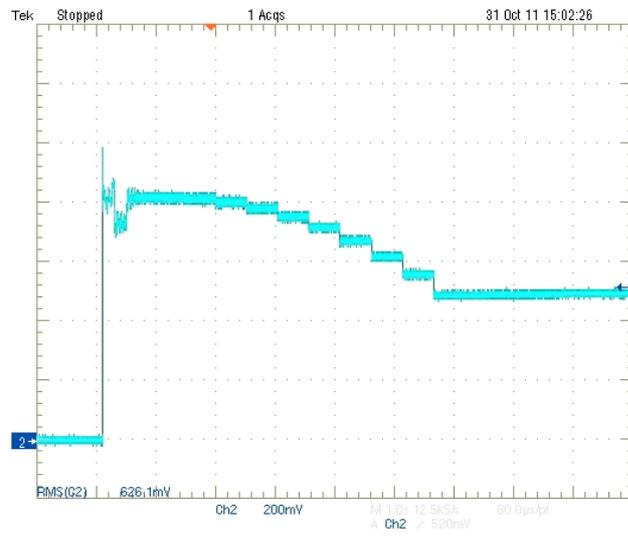
Figura 4.9: Sobreimpulso de corriente. Ch2: 10 A/div; tiempo: 1 s/div.
