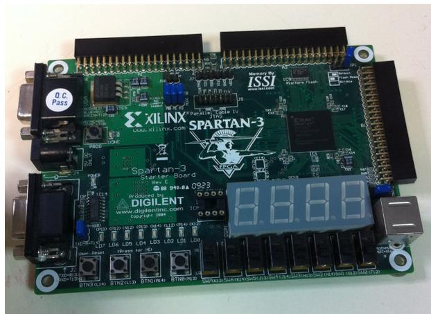
Figura 4.5: Circuito de control con FPGA de Xilinx® Spartan3 (XC3S200).
