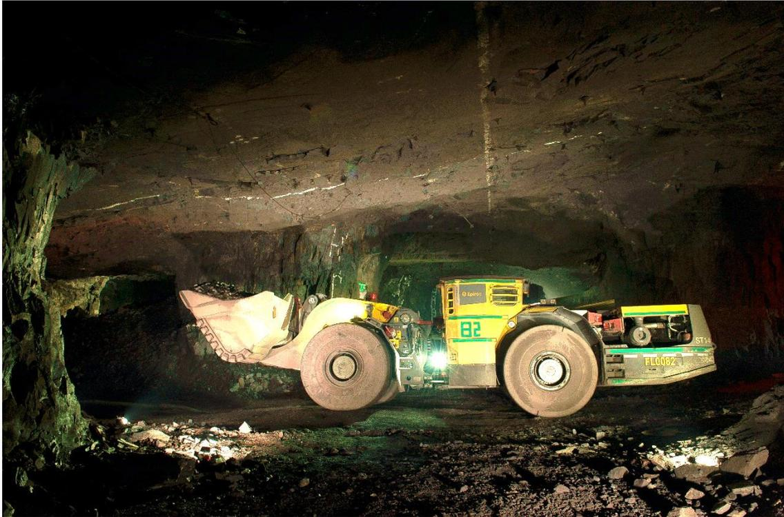
*Ilustración 3.1: Frontal cargadora de perfil bajo (Fuente: Pixabay)*
