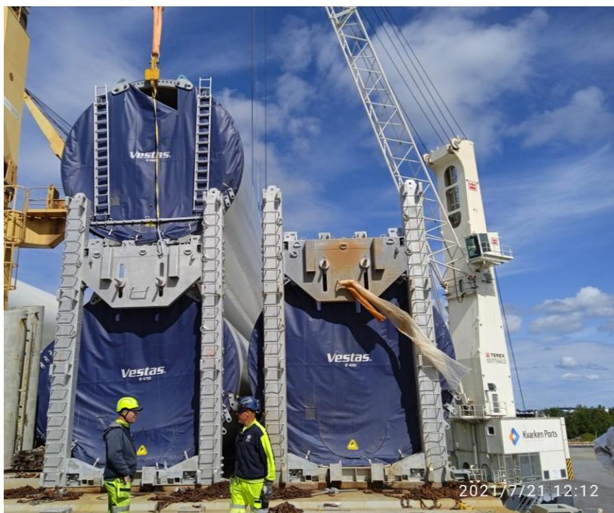
Ilustración 14 Torres estibadas en dos alturas en cubierta. Fuente: Autor.
