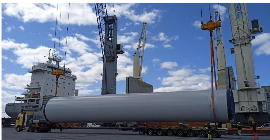
*Ilustración 16 Torre siendo cargada en el camión. Fuente: Autor.*
