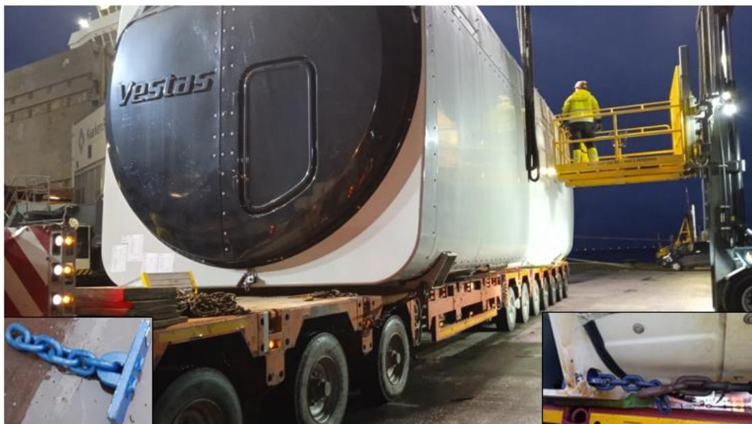
Ilustración 22 Nacelle cargado en el camión, con detalles de sus elementos de trinca. Fuente: Autor.
