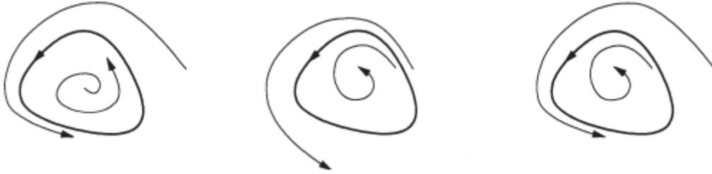
Figura 5: A la izquierda, ciclo límite estable. Las trayectorias vecinas se acercan a él. En medio, ciclo límite inestable. Las trayectorias vecinas se alejan de él. A la derecha, ciclo límite semiestable. Algunas trayectorias vecinas se alejan y otras se acercan a él. Imagen obtenida de [12].
