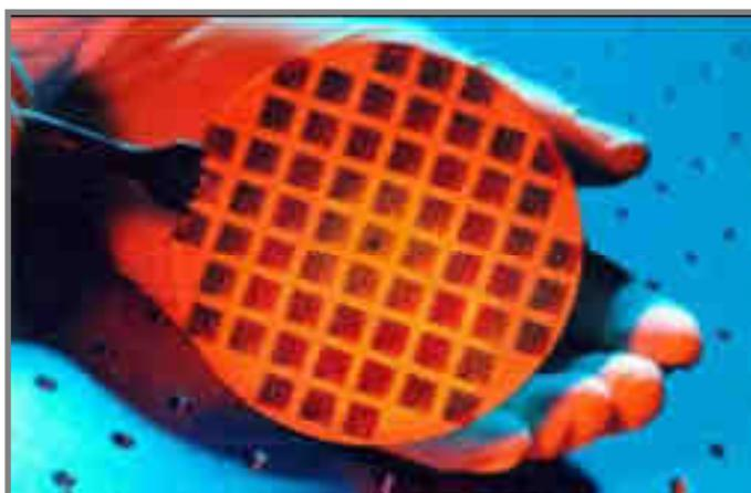
**FIGURA 1.1.5** Resultado final del proceso de fabricación de obleas de silicio.
