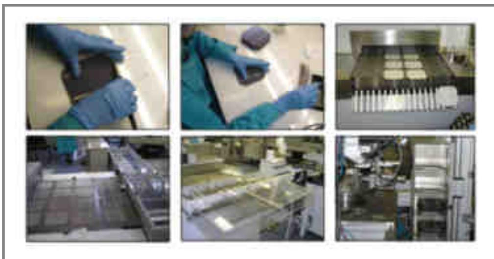
**FIGURA 1.1.6** Diferentes etapas del proceso de fabricación de obleas para paneles fotovoltaicos.
