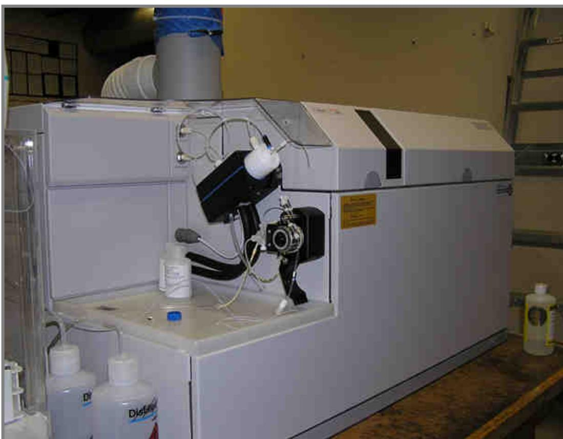
**FIGURA 2.2.1** ICP-MS de *Agilent Technologies*.
