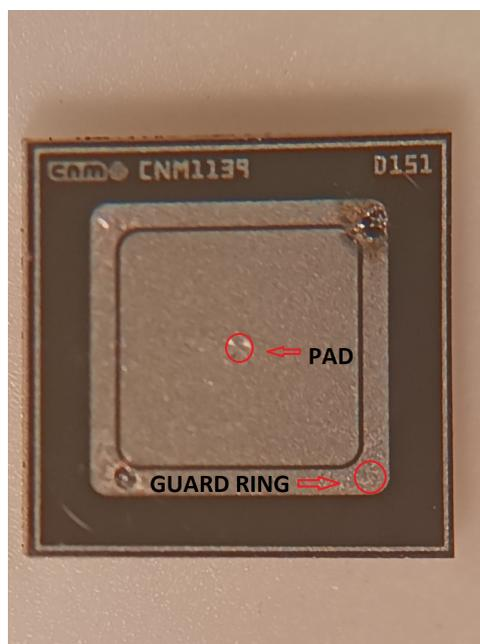
Figura 3.2: La imagen de un sensor LGAD. Mostrando los puntos donde se contactan con las sondas a la hora de realizar las medidas.
