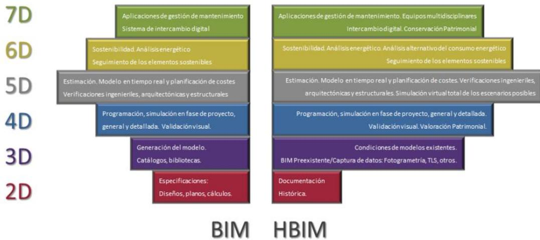
Ilustración 9. Representación de 7D BIM vs. 7D HBIM
