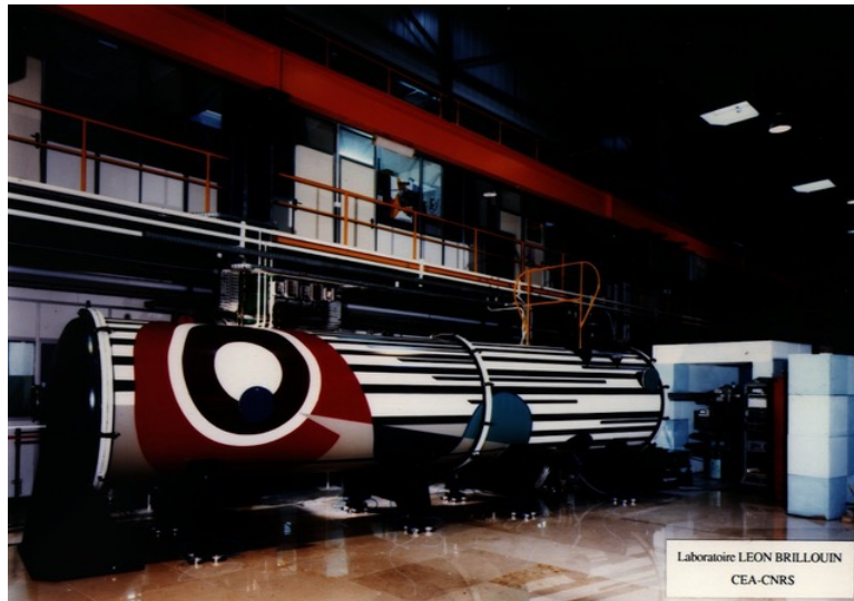
Figure 18: Imagen del difractómetro PAXY del laboratorio Leon Brillouin de Francia en la que se realizaron los experimentos del SANS. La longitud de onda incidente fue de \lambda = 5 \text{ \AA} y el detector fue colocado a distancias de 1.3 m y 6 m. El rango de Q cubre 0.003 \text{ \AA}^{-1} \ll Q \ll 0.2 \text{ \AA}^{-1} .
