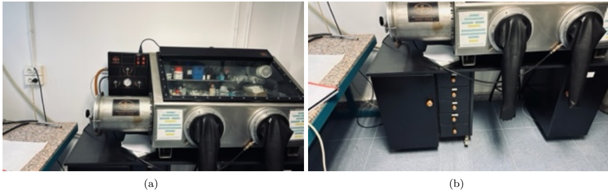
Figure 12: Caja de guantes donde se encontraban guardaban las tres muestras de TbAl_2 . Esta caja aloja muestras en atmósfera de Ar.
