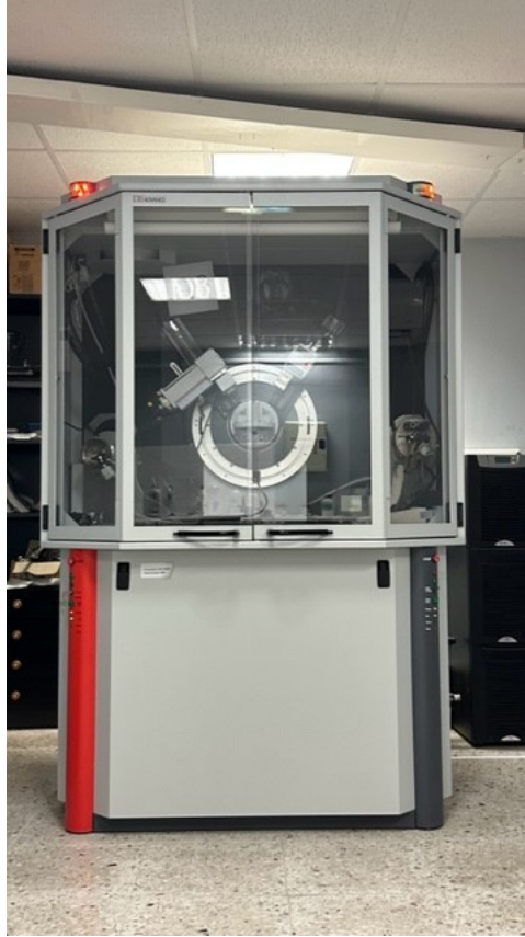
Figure 13: Difractómetro de Rayos X de la Universidad de Cantabria. Es un difractómetro en configuración \Theta - \Theta . En la parte superior se puede observar el goniómetro, el tubo de rayos x a la izquierda y el detector a la derecha formando un cierto ángulo \Theta ambos. La longitud de onda utilizada es la correspondiente a Cu - K\alpha con \lambda = 1.5418 \text{ \AA} .
