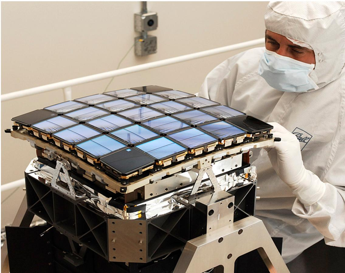
Figura 1.6: Plano focal del satélite con los 42 CCDs colocados en 21 de los 25 módulos se empleaban para realizar observaciones. Los otros cuatro módulos se utilizaban para guiar el satélite (*Kepler focal plane assembly*).
