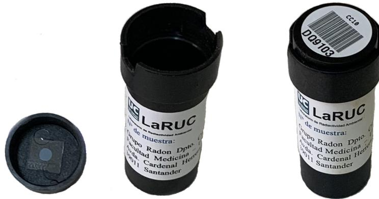
Figura 6: Imágenes de un detector CR39 abierto y cerrado. A la izquierda puede verse el polímero pegado a la parte superior de la tapa.
