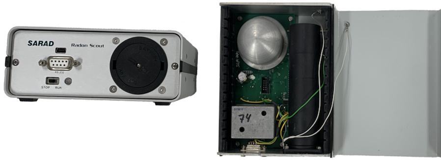
Figura 4: Imágenes del SARAD RadonScout. A la izquierda la vista frontal donde se encuentran todas las conexiones. A la derecha una imagen del interior, donde se destaca el detector semiconductor de alto voltaje en la parte superior izquierda.
