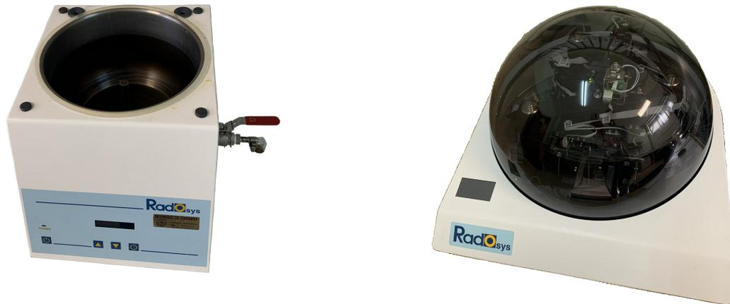
Figura 7: (Izquierda) Radobath, dispositivo donde se realizaron los baños de NaOH y ácido acético glacial para el revelado de las trazas en los detectores. (Derecha) Radometer, sistema óptico conectado a un ordenador donde se realizaron los conteos automáticos de las trazas en los detectores.
