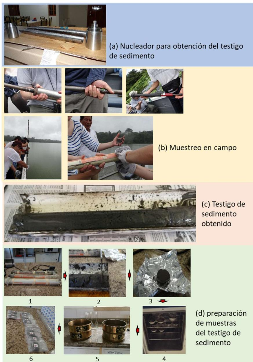
Fig. 19. (a) Nucleador para obtención del testigo de sedimento, (b) Muestreo en campo; (c) Testigo de sedimento obtenido; (d) preparación de muestras del testigo de sedimento
