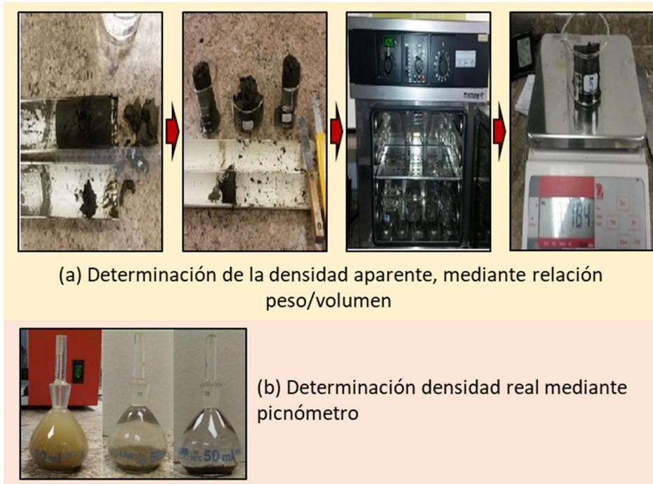
**Fig. 16: Determinación de la densidad (a) aparente, mediante relación peso/volumen y (b) real mediante picnómetro**
