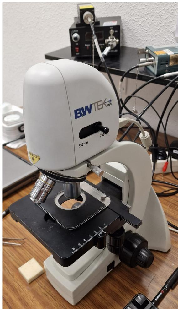
Figura 3: Espectrómetro portátil usado para la obtención de los espectros de luminiscencia del rubí en el experimento inicial.
