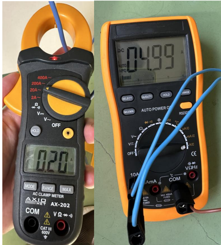
Figura 29. Medida de corriente AC en pinza Figura 30. Medida de corriente DC en multímetro (fuente: Elaboración propia) (fuente: Elaboración propia)
