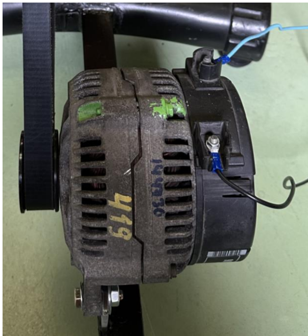
Figura 23. Conexión del alternador (fuente: Elaboración propia)
