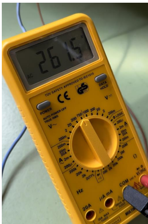
Figura 31. Medida de tensión AC en multímetro (fuente: Elaboración propia)
