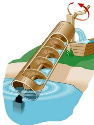
Figura 3.2: Tornillo de Arquímedes. [7]
