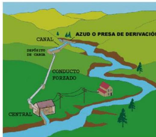
Figura 2.1: Central hidroeléctrica de agua fluyente. [2]
