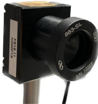
Figura (5). Imagen del sensor de frente de onda Shack-Hartmann empleado en el desarrollo del trabajo.
