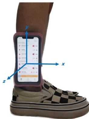
Figura 3.1: Disposición del móvil en el tobillo con la dirección de cada eje
