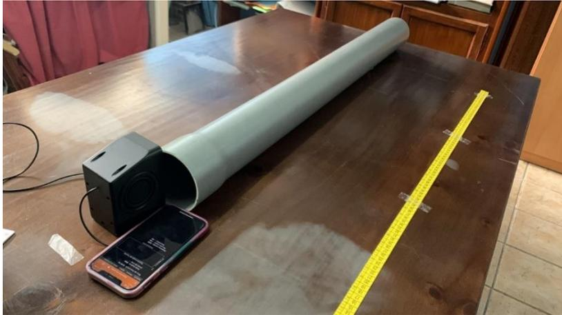
Imagen 29. Montaje experimental para el caso de un tubo semi cerrado.
