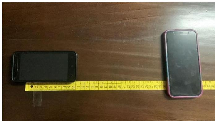
*Imagen 17. Disposición de los smartphones para la medida de la intensidad y su variación con la distancia.*
