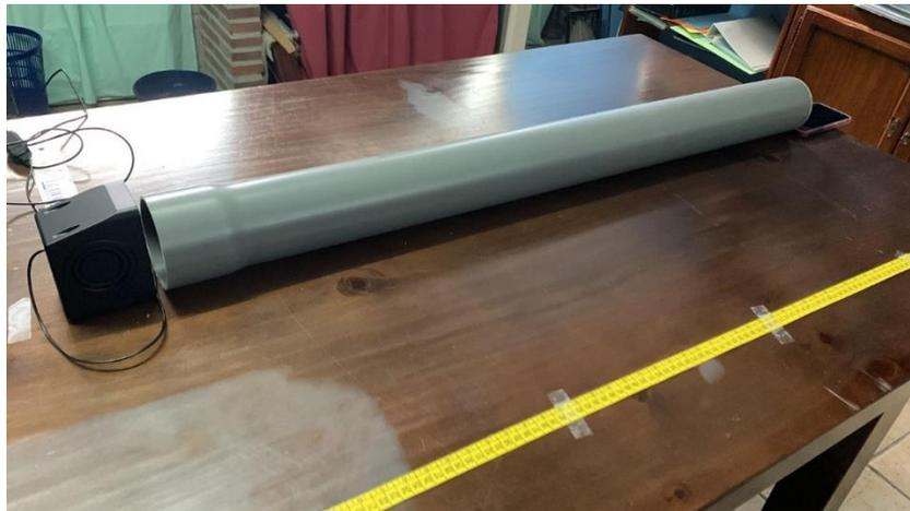
*Imagen 28. Montaje experimental para el caso de un tubo abierto por los dos extremos*
