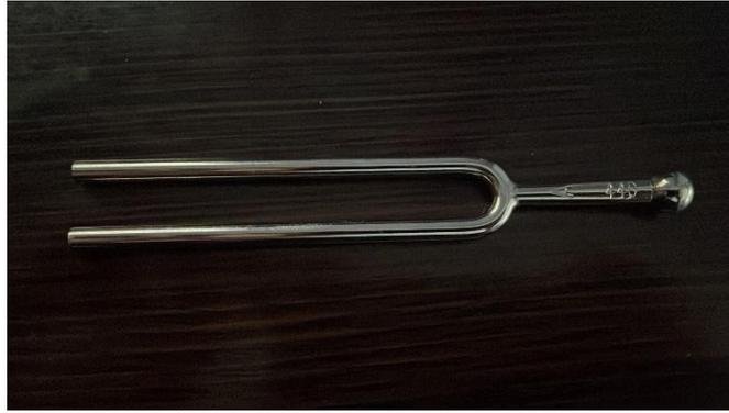
*Imagen 9. Fotografía de un diapasón diseñado para que su frecuencia fundamental sea 440 Hz*
