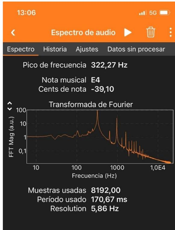
**Imagen 15.** Captura de pantalla del espectro de audio obtenido al hacer vibrar la primera cuerda de una guitarra, donde se observa el pico correspondiente a la frecuencia fundamental y los armónicos.
