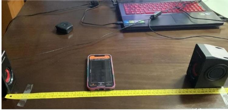
*Imagen 33. Dispositivo experimental para el estudio de las interferencias sonoras.*
