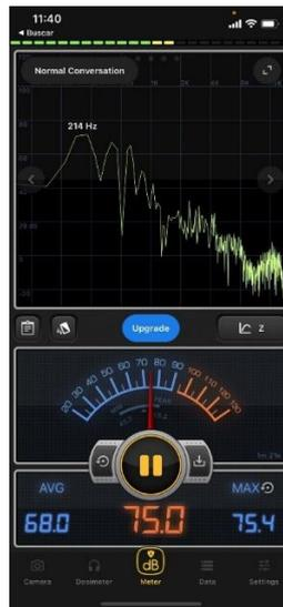
*Imagen 2. Captura de pantalla de la aplicación DecibelX, que muestra el espectro de la onda y mide el Nivel de Presión Sonora en dB*
