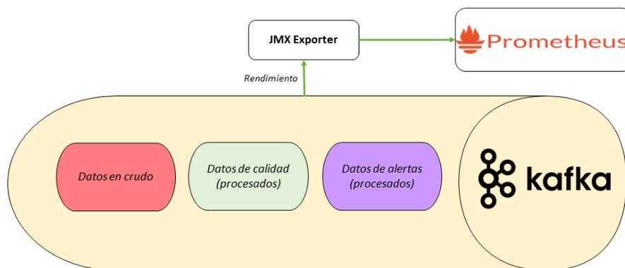
Figura 12: Componentes implicados en la monitorización del rendimiento.
