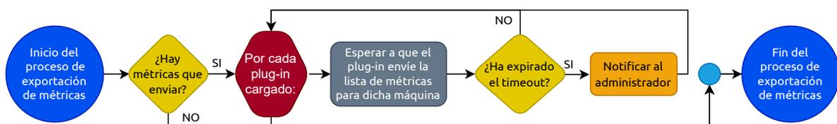
Figura 5.4: Diagrama de flujo de ejecución del proceso de exportación de métricas
