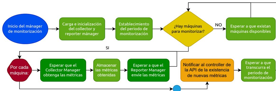
Figura 5.2: Diagrama de flujo de ejecución del manager del sistema de monitorización
