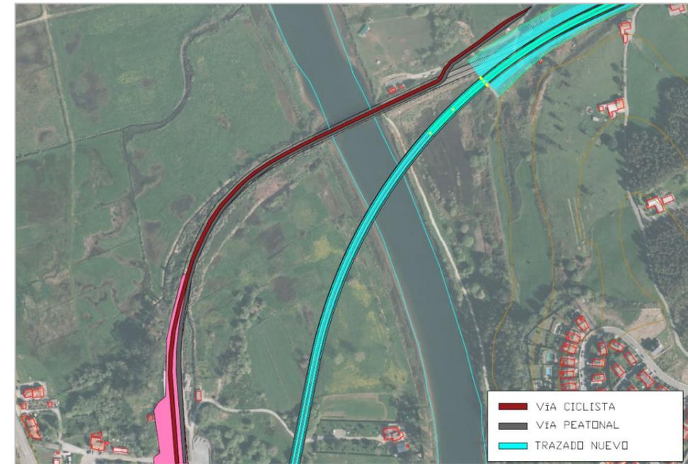
Ilustración 20 – Propuesta en planta de senda ciclable sobre el antiguo puente sobre el río Pas. Fuente: Autor
