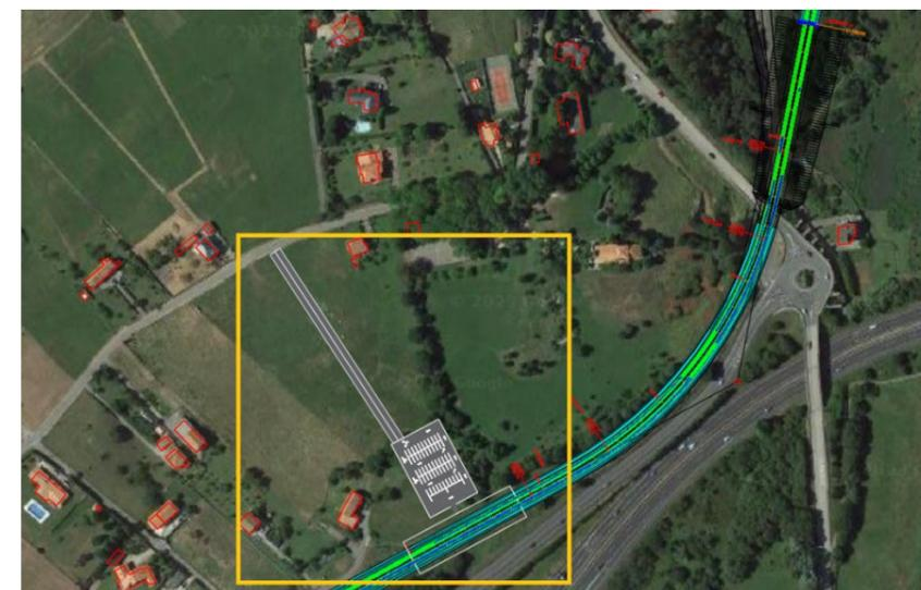
Ilustración 17 – Vista en planta de la estación, aparcamiento y vía de acceso de Mogro. Fuente: Autor
