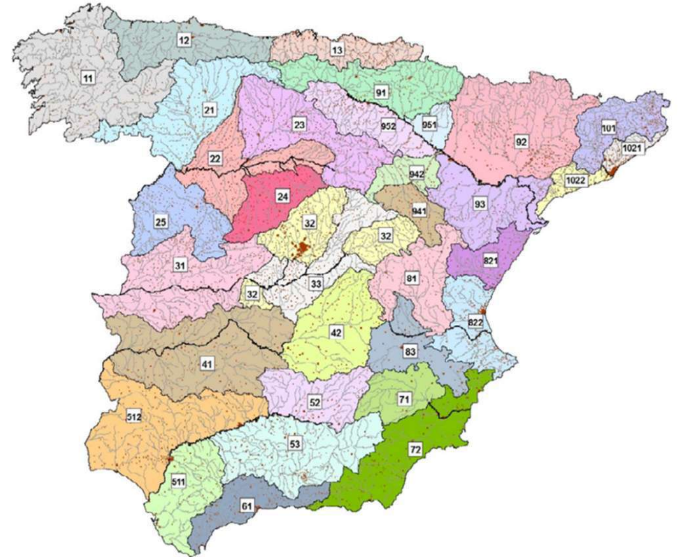
Imagen 3. Regiones para la caracterización del coeficiente corrector del umbral de escorrentía.
