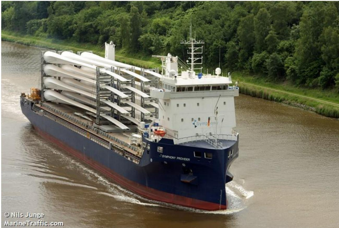
Figura 11.9. Symphony provider transportando palas de aerogeneradores.
