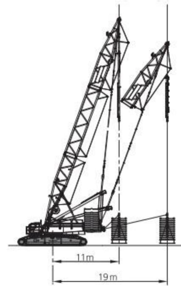
Figura 11.4. Vista lateral en carga grúa CC 3800-1
