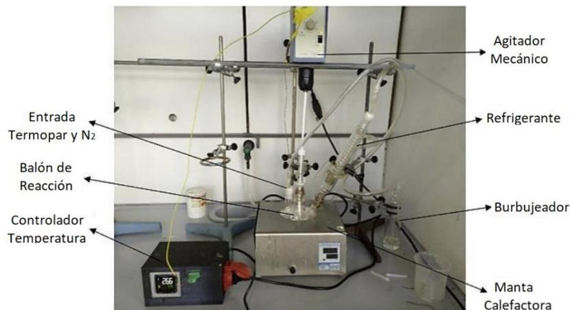
**Figura 3.** Montaje experimental para la síntesis de oleato de hierro(III) y de las nanopartículas de magnetita.
