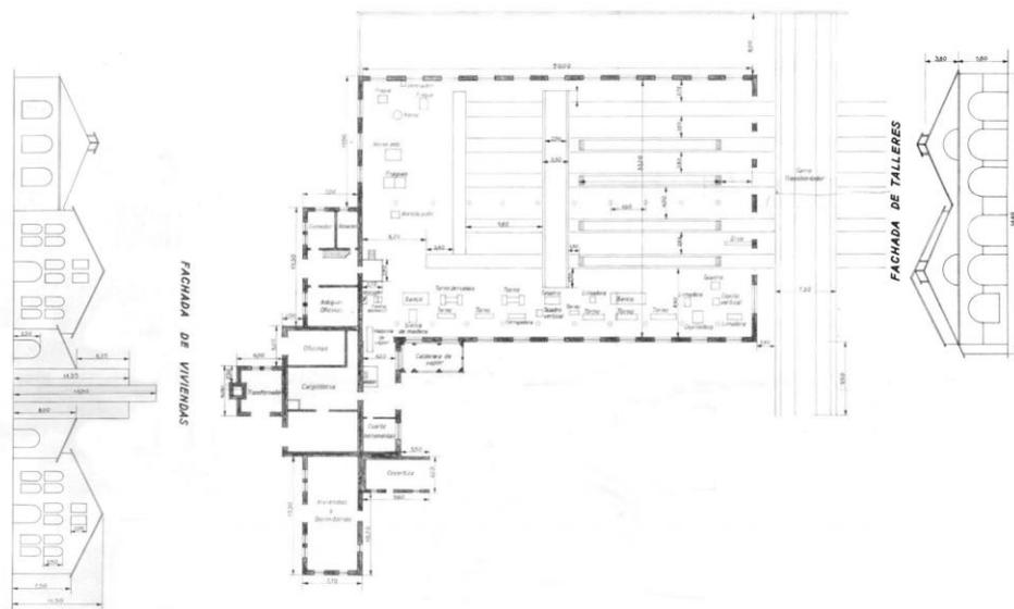
**Figura 4.4:** Planta y fachadas del antiguo taller ferroviario de Cajo con todas sus dependencias. Se aprecian también las cinco vías y los cuatro fosos
