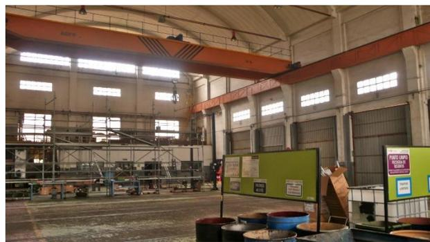
**Figura 4.18:** Interior de la nave transversal: Se aprecia el puente grúa
