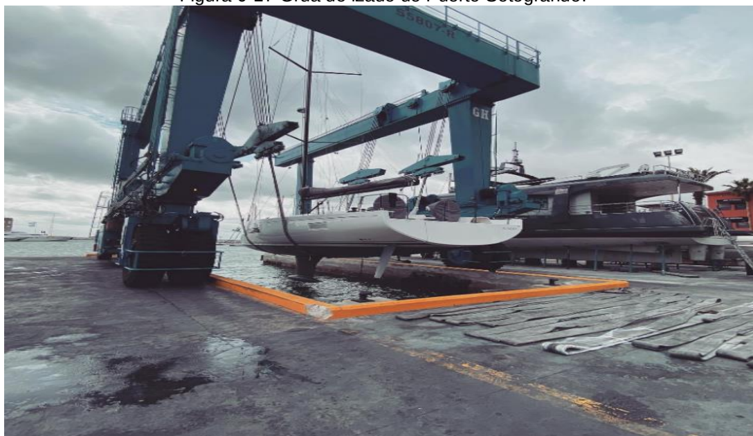
Figura 0-17 Grúa de izado de Puerto Sotogrande.
