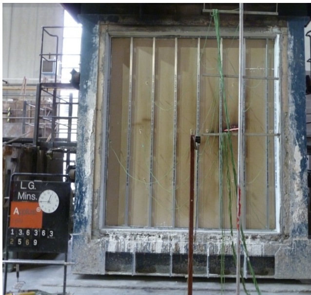
Fig. 74 Ensayo 2: Fallo del sistema.
