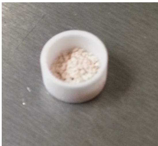
Fig. 21 Muestra de yeso una vez preparada en el portamuestras de STA.
