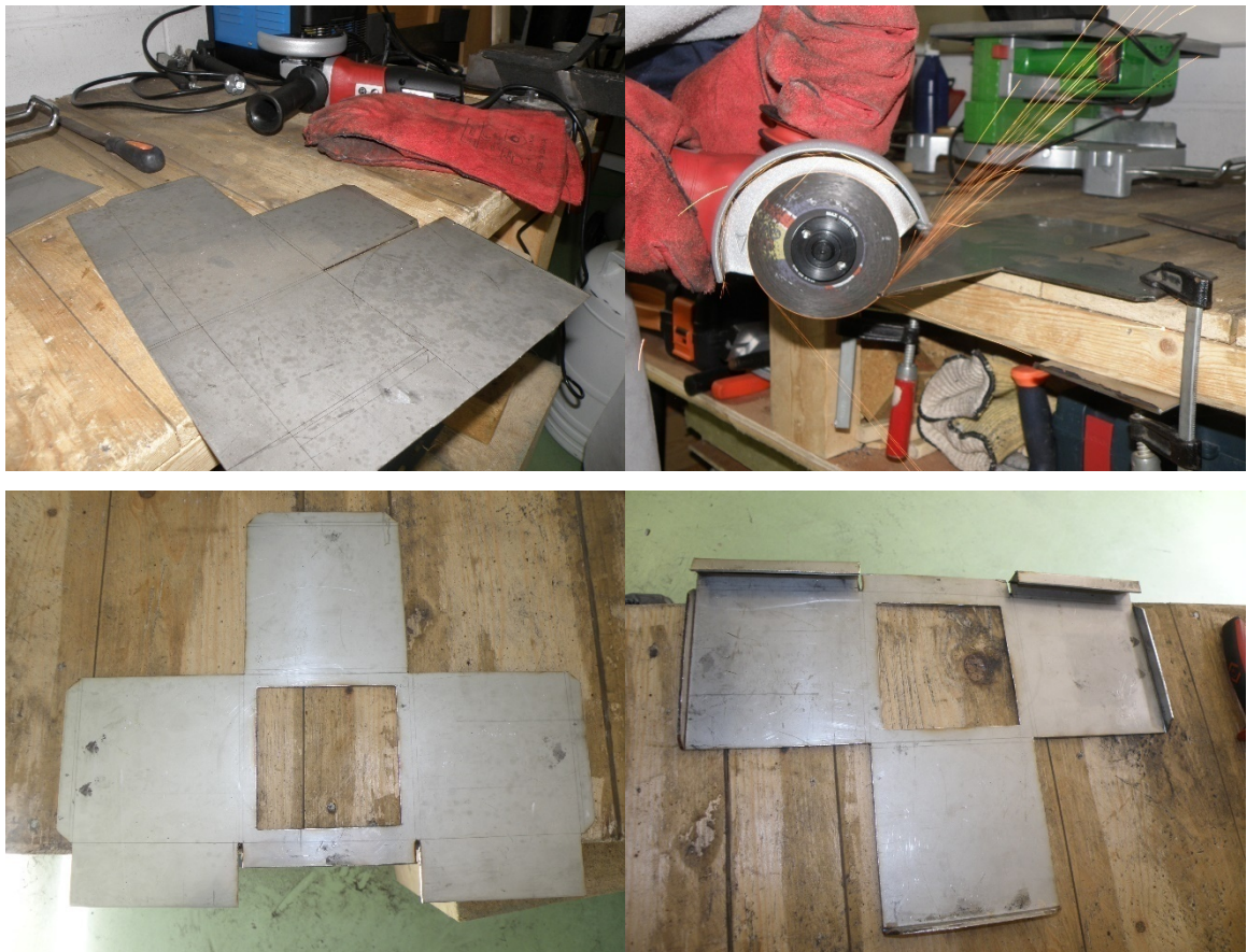
Fig. 42 Montaje del portamuestras.
