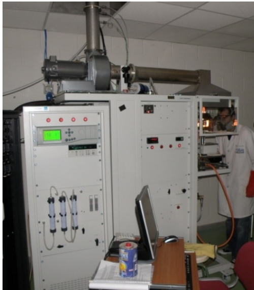
Fig. 40 Cono calorimétrico disponible en el Laboratorio del Grupo GIDAI
